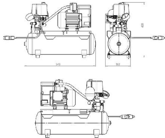
Armatureneinheit mit Druckschalter, Rückschlagventil, Manometer Sicherheitsventil, mechanische Anlaufentlastung, Kondensatmagnetventil, Schnellkupplung und Schlauchtülle
